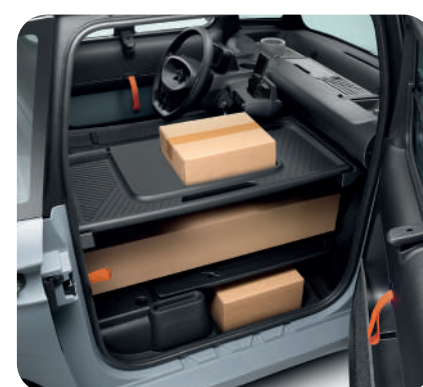
Bandeja superior que puede soportar un peso de 40 kg
